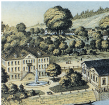
Weltpitzentechnologie im Letten: Im Hofmeister'schen Etablissement diente 1790 ein Springbrunnen als Druckanzeiger für die Walken und Pressen der Kattundruckerei. Rechts das heutige EWZ, hinter dem Springbrunnen die ehemalige Textilfachschule. (BAZ)
