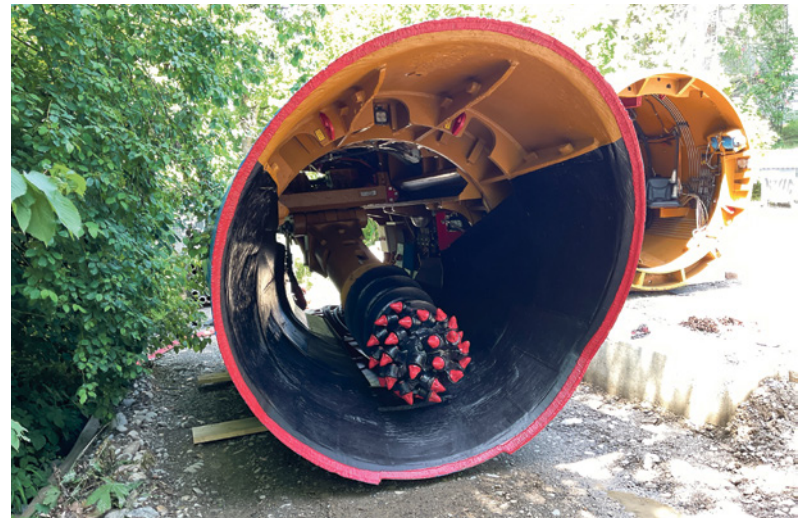
Das war vor einem Jahr: Der Schrämmkopf der Tunnelbohrmaschine vor seinem Einsatz in der Winzerhalde. (Foto: das)
