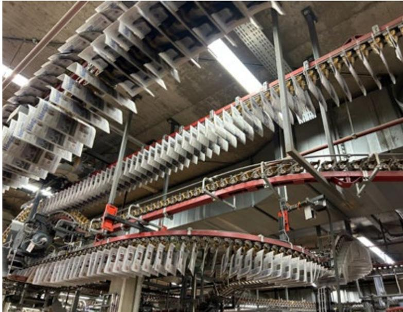
Da düsen sie vorbei: Hunderte Exemplare der «Höngger Zeitung» vom 18. April, die frisch aus der Druckmaschine kommen. In einem ausgeklügelten Schienen-System im Druckzentrum Zürich werden die Zeitungen an der Decke transportiert. (dad)
