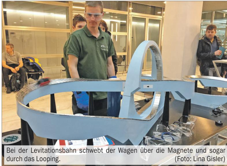
Bei der Levitationsbahn schwebt der Wagen über die Magnete und sogar durch das Looping. (Foto: Lina Gisler)
