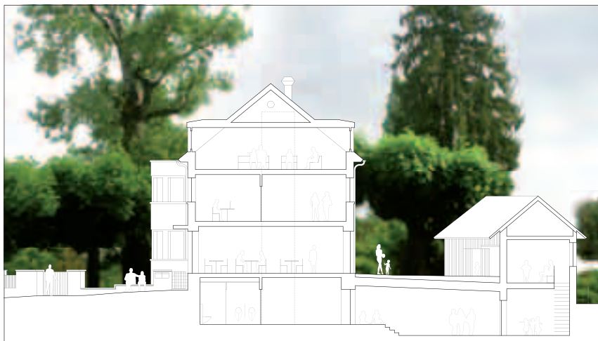
Querschnitt mit neuer Unterkellerung.
