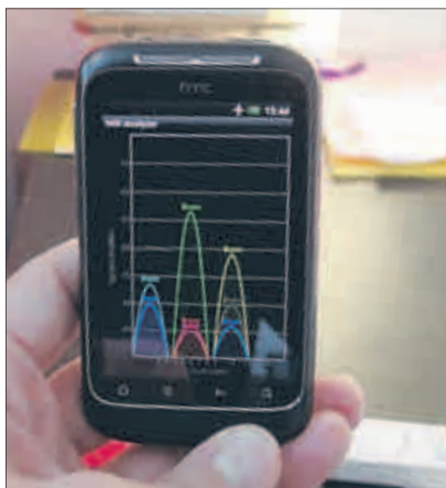
Zwei Messungen zeigen es auf, die gelbe Kurve zeigt jeweils den zimmereigenen Sender an: Oben wurde direkt am IT-Wagen gemessen, unten wurde gegenüber, auf der anderen Seite des Schulzimmers, gemessen – die gelbe Linie zeigt, wie stark dort die Sendeleistung noch ist, die grüne Kurve zeigt bereits den Sender des Nachbarzimmers an. (Fotos: Martin Zahnd)
