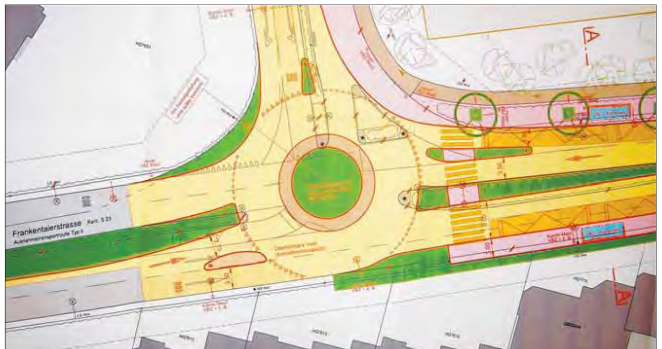
Die bisherige T-Einmündung der Geeringstrasse (von oben) in die Frankentalerstrasse wird zu einem Kreisel umgebaut. Auf der Frankentalerstrasse entstehen auf jeder Strassenseite je eine neue Bushaltestelle (orange) für die beiden VBZ-Linien 46 und 89 sowie für die Regionalbusse nach und von Regensdorf. Die Buslinien erhalten in den Kreisel hinein je eine eigene Fahrspur. Für den Individualverkehr auf der Umfahrungsachse Frankentalerstrasse inklusive der Zufahrten in und aus der Geeringstrasse steht noch je eine Fahrspur zur Verfügung. (zvg)
