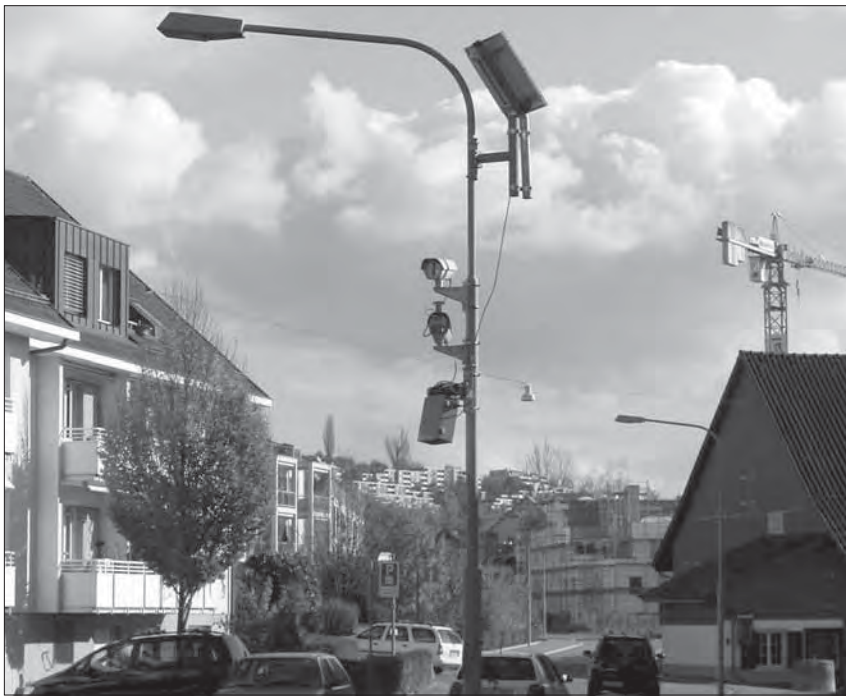
Solche Kameras, wie diese an der Riedhofstrasse, zählen die Fahrzeuge.
