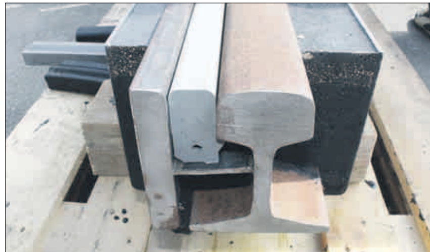
Ein Querschnitt der neuartigen Gleise, welche auf 90 Metern verlegt wurden: In der Mitte ist die graue Gummifüllung gut zu erkennen. (Fotos: Malini Gloor)
